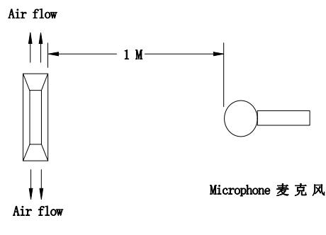
(在背景噪音不超过 18dB (A) 的无响室内，将待测风扇通入额定的工作电压，悬掉入空中，将麦克风放于风扇同一平面且离待测风扇进风口一米处进行测试其 B&K 值)
