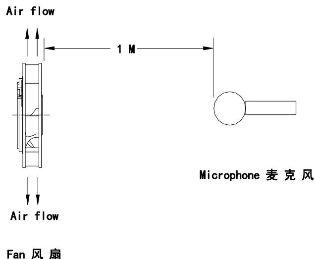
(在背景噪音不超过 18dB (A) 的无响室内，将待测风扇通入额定的工作电压，悬掉入空中，将麦克风放于风扇同一平面且离待测风扇进风口一米处进行测试其 B&K 值)
