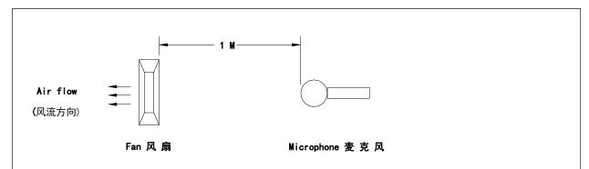
(在背景噪音不超过 18dB (A) 的无响室内, 将待测风扇通入额定的工作电压, 悬掉入空中, 将麦克风放于风扇同一平面且离待测风扇进风口一米处进行测试其 B&K 值)
