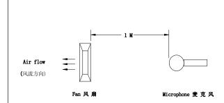
(在背景噪音不超过 18dB (A) 的无响室内,将待测风扇通入额定的工作电压,悬掉入空中,将麦克风放于风扇同一平面且离待测风扇进风口一米处进行测试其 B&K 值)
