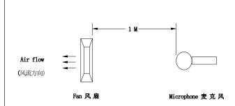
(在背景噪音不超过18dB(A)的无响室内,将待测风扇通入额定的工作电压,悬掉入空中,将麦克风放于风扇同一平面且离待测风扇进风口一米处进行测试其 B&K 值)
